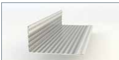
7. Cembrit Ventilationsprofil 22 x 50 mm prælakeret aluminium. Start- og slutprofil til Cembrit paneler
