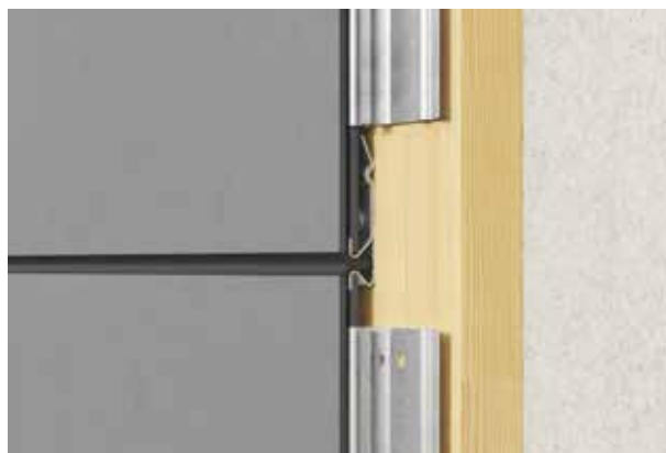
Montageprofiler til Cembrit Pure System monteres på lodrette afstandslister, så der er fri lodret ventilation.
