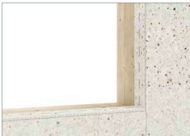
Princip "tæt" regnskærm
